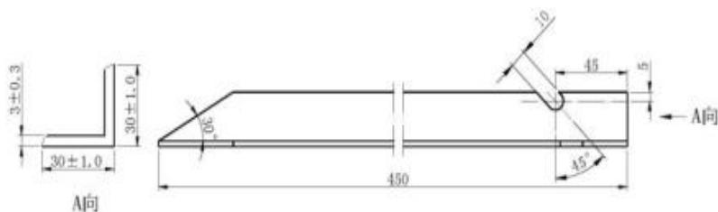
图 D.1 三角桩结构及主要尺寸
