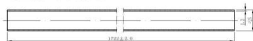
图 B.2 立杆结构及主要尺寸
