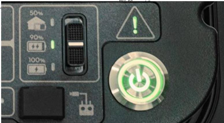
电池箱内部接口（绿色显示充电中）
