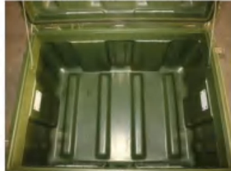
密封试验后，内部无渗水。
