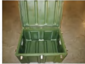
低温工作试验后，可正常开合。
