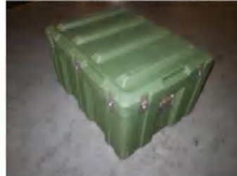
压力试验后，样品无变形。
