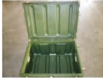
高温工作试验后，可正常开合。
