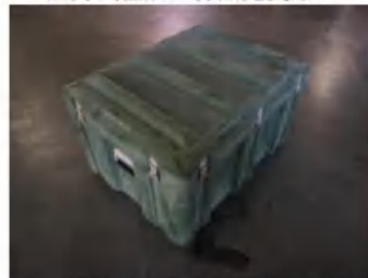
低温跌落试验后，样品无变形，配件无损坏。
