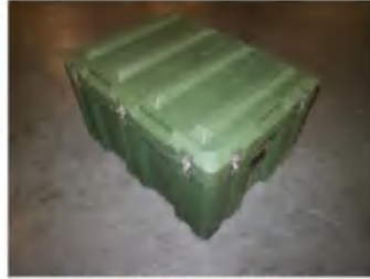
盐雾试验后，样品无锈蚀。
