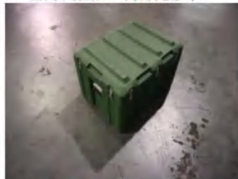
堆码试验后，样品无变形。
