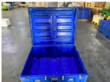
样品内部无渗水。
